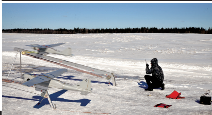
Этап лётных сертификационных испытаний гражданского БВС «Орлан-10» в Сертификационном центре АО «Авиапром»
